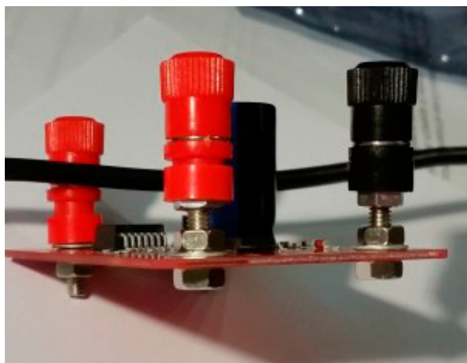
Fig. 1 – boccole montate in modo da creare il minimo ingombro sotto lo shield.
