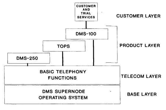
TOPS TRAFFIC OPERATOR POSITION SYSTEM DMS-250 TANDEM SWITCH FOR LONG DISTANCE TRAFFIC
