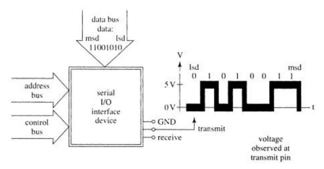
Fig. 8.19 Serial output
