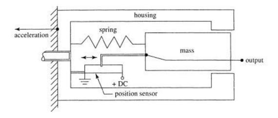
Fig. 1.28 Accelerometers
