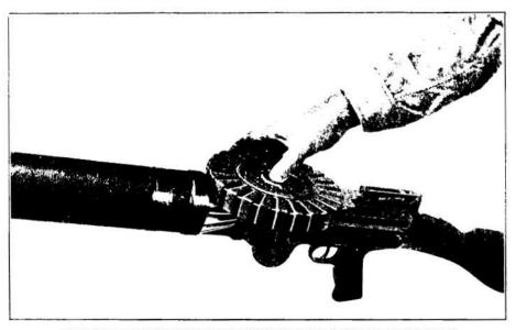
PLATE XII- VIEW SHOWING PROPER METHOD OF PLACING MAGAZINE ON MAGAZINE POST
