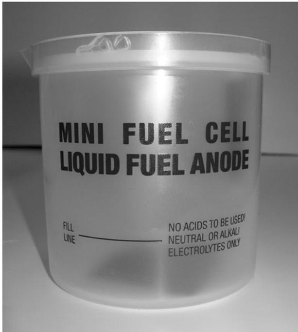
Figure 6-7 The mini alkaline fuel cell anode.
