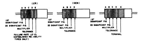
COLOR CODE MARKING FOR COMPOSITION TYPE RESISTORS
