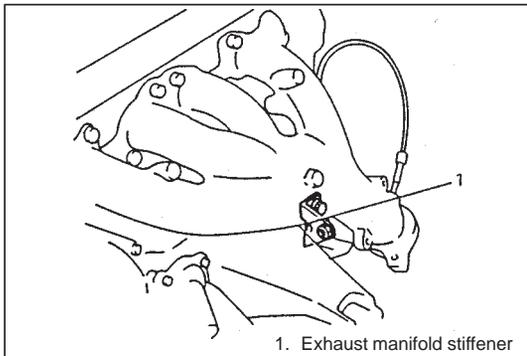
14) Remove exhaust manifold stiffener (if equipped).
