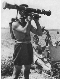
Oben: Der K5 trägt auf einem Schultergestell ein Entfernungsmessgerät 1m R36 (Em 1m R36). Der Behälter, den der K5 auf dem Rücken trägt, enthält die Beleuchtungseinrichtung des Messgerätes. (BA)
