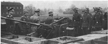
Flak 30 auf der linken Seite der Lafette. Klar erkennbar sind je ein Handrad für die Höhen- und Seitenrichtmaschine, sowie der Visiertragarm mit dem Flakvisier 35 und dessen Steuergestänge.
