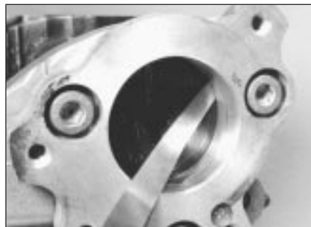
10.12 Checking camshaft endfloat
