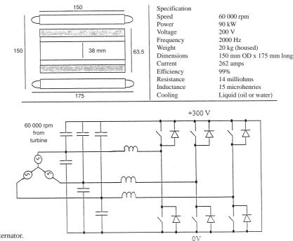
Fig. 1.13 Turbo alternator.
