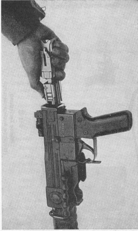
Bild 22 Einführen des Verschlusses
