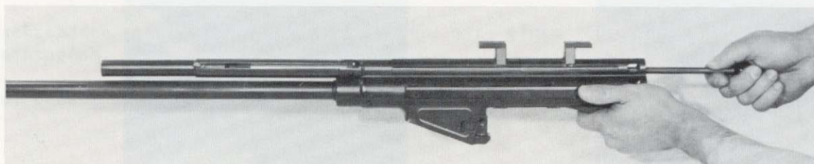
Durchladerohr richten und prüfen
