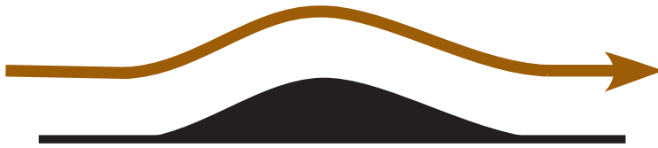
Fig. 8.2. The “half” venturi.
