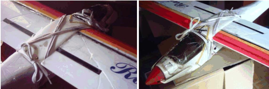
Endlösung: 2 Schnürsenkel. Hält Tragfläche und Akkufach zugleich. **Nie wieder Gummis.** Außer ich schneide sie aus alten Fahrradschläuchen.
