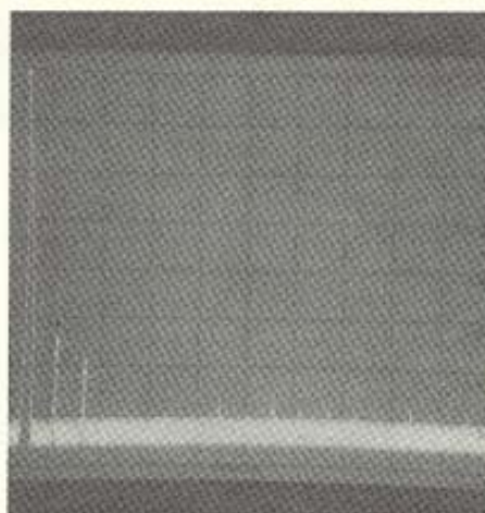
ICOM IC-701 DIAGRAMMA FOTOGRAFICO DELL'ANALISI DI SPETTRO DEL TRASMETTITORE IN CE A PIENA POTENZA A 28 MHz. ASCISSE 50 MHz/DIVISIONE, ORDINATE 10 dB/DIVISIONE. IL PICCO MASSIMO A SINISTRA RAPPRESENTA LA FONDAMENTALE. DINAMICA TOTALE -70 dB DAL PICCO MASSIMO.
