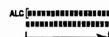
Règle la valeur [COMP Level] à l'aide du vernier de réglage, de sorte à ce que l'indicateur de niveau COMP ne dépasse pas la limite de la zone de niveau COMP.
