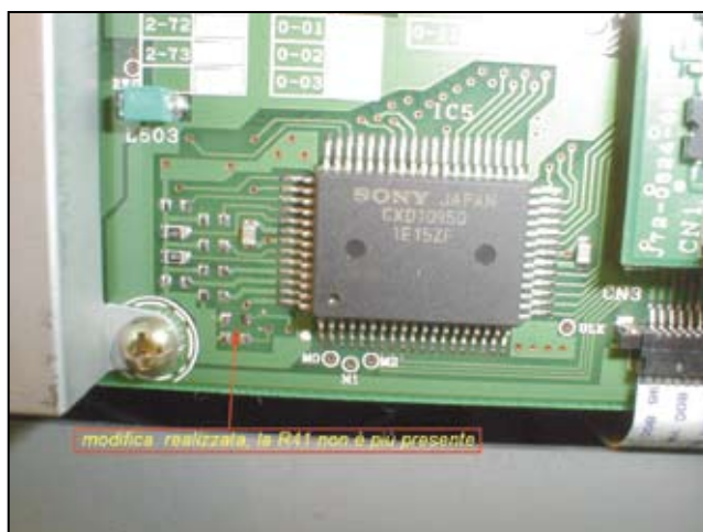
Foto 4B - Particolare della control board dopo la modifica
