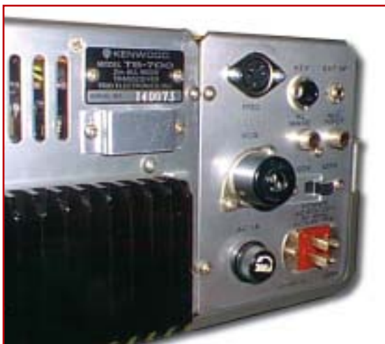
foto 4 Intervento, sul retro dell'apparato, per installare la presa DIN 5 poli
