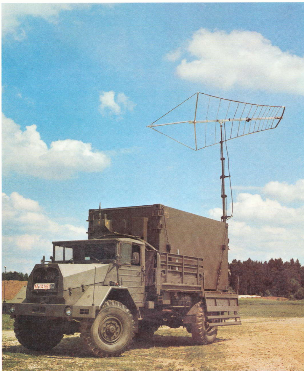
BILD 1 Faltbare logarithmisch-periodische Sende-Empfangsantenne HL 026 für 27 bis 87 MHz im Betriebszustand. Foto 28737/2
