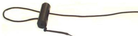
tensionatore delle linee alla fine di un tirante
