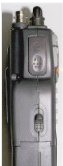
Die zierliche Sendetaste ist durch eine Mulde doch gut zu ertasten. Darüber die unverzichtbare Zweitfunktionstaste.
