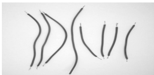
Figure 7. Câbles coupés et dénudés
