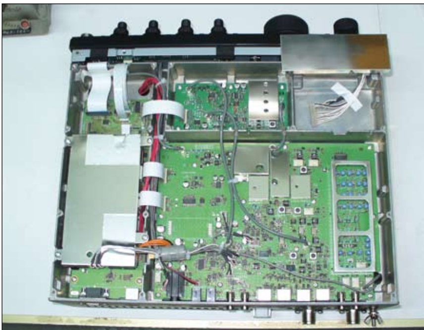
FTdx 1200 telaio ricevitore; nel telaio senza coperchio visibili i filtri di banda
