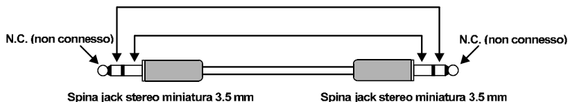
Percorso Cavi "CT-35"
