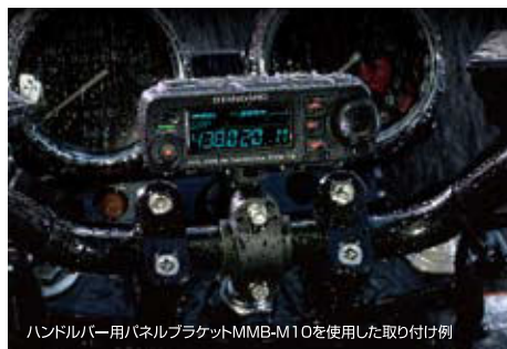
ハンドルバー用パネルブラケットMMB-M10を使用した取り付け例
