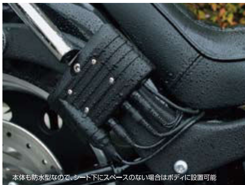
本体も防水型なので、シート下にスペースのない場合はボディに設置可能
