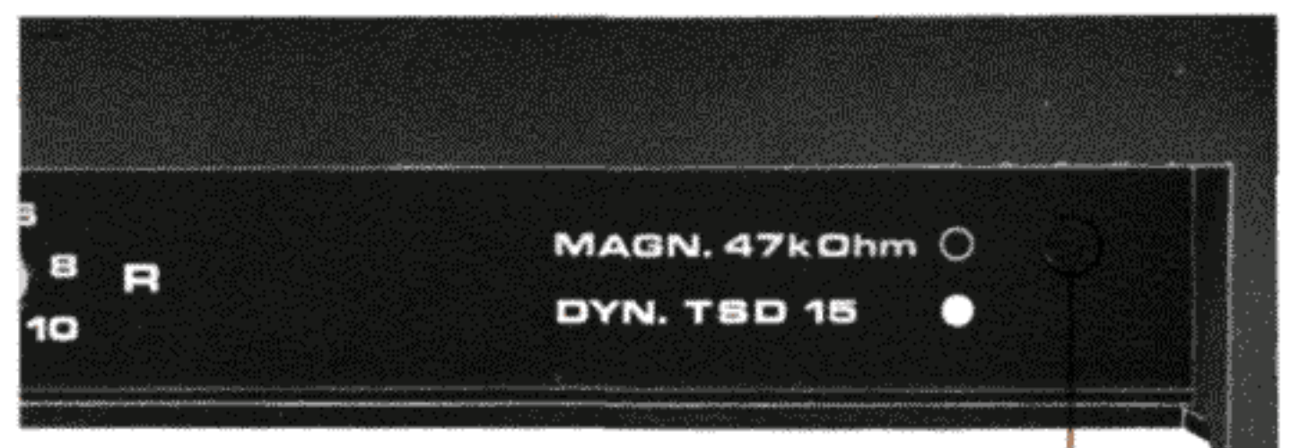
Kein weißer Punkt sichtbar: Gerät auf 47 kOhm Eingangswiderstand geschaltet.
