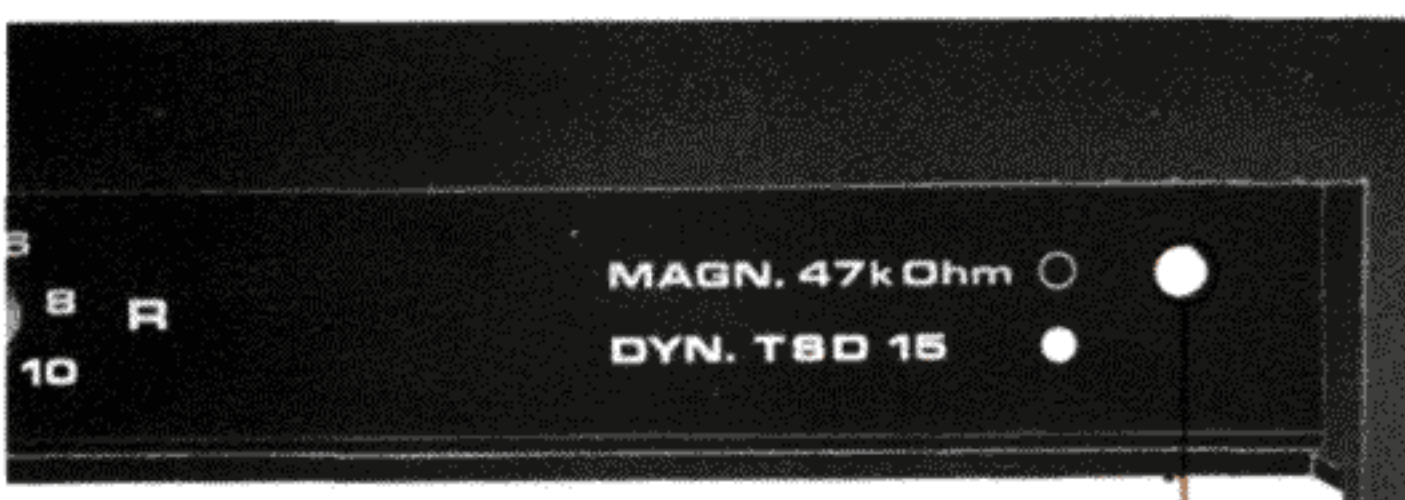
Weißer Punkt sichtbar: Aktiver Impedanzwandler (Preamplifier) ist eingesteckt.
