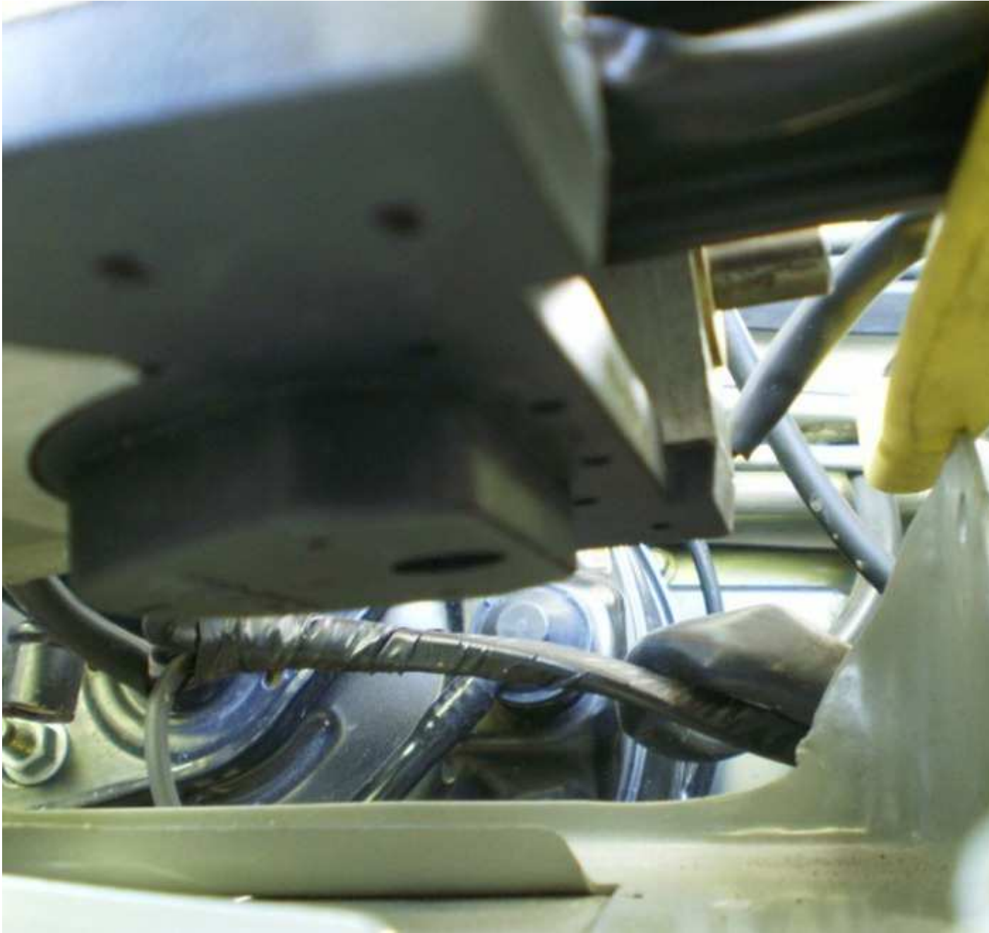
26. Reposition the PAS Fluid reservoir.
