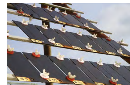
Unter freiem Himmel müssen die Bleche der B-Probe Wind und Wetter auf Sylt trotzen
