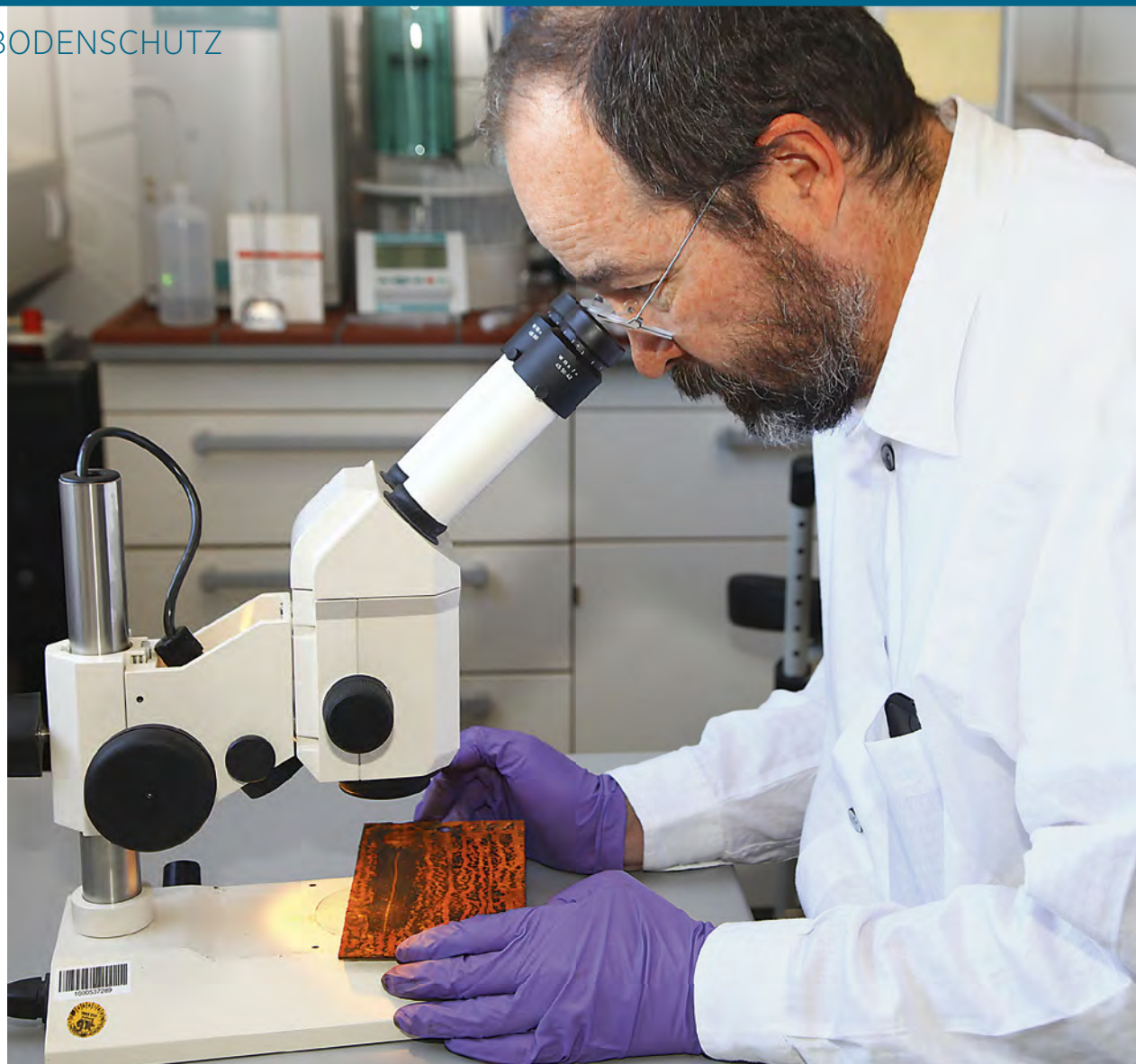
Wie tief die Rostnarben wirklich sind, erkennt man oft erst unter dem Mikroskop. So wäre es eine Untertreibung, wenn wir sagen würden, Dr. Erning, habe die Bleche lediglich „unter die Lupe genommen“. Korrosion ist das Fachgebiet des Chemikers
