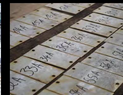
Thomas Geis legt die angerosteten Bleche zur Auslösung bereit. Sie sind von hinten weiß lackiert und in drei Gruppen beschriftet
