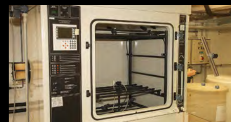
...ausnahmslos aus Kunststoff. Jegliches Metall könnte das Ergebnis beeinflussen
