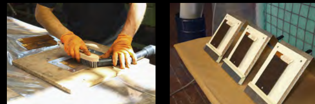
Mit einer Drahtbürste entfernt Thomas Geis den Rost, bevor er die Bleche in eigens angefertigten Ständern platziert
