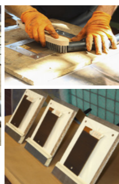
Thomas Geis bereitet in Schweinfurt die angerosteten Bleche vor, die dann zugelost wurden. Groben Rost bürstete er ab, zur Beschichtung lagen insgesamt vier neue Saugbecherpistolen bereit
