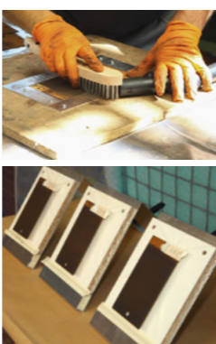
Thomas Geis bereitet in Schweinfurt die angerosteten Bleche vor, die dann zugelost wurden. Groben Rost bürstete er ab, zur Beschichtung lagen insgesamt vier neue Saugbecherpistolen bereit
