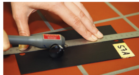
Alle Proben wurden gleichmäßig mit einem speziellen Stichel angeritzt
