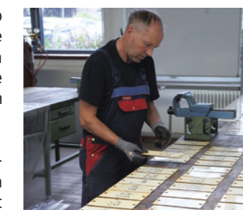
Thomas Geis bereitet in Schweinfurt die angerosteten Bleche vor, die dann zugelost wurden. Groben Rost bürstete er ab, zur Beschichtung lagen insgesamt vier neue Saugbecherpistolen bereit
