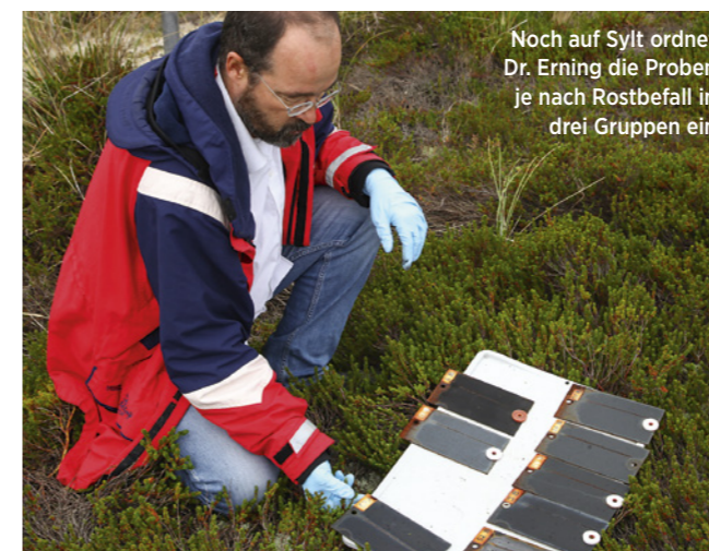
Bloß nicht anfassen! Fingerabdrücke könnten das Ergebnis verfälschen. Selbst die Halteschrauben bestehen aus neutralem Kunststoff
