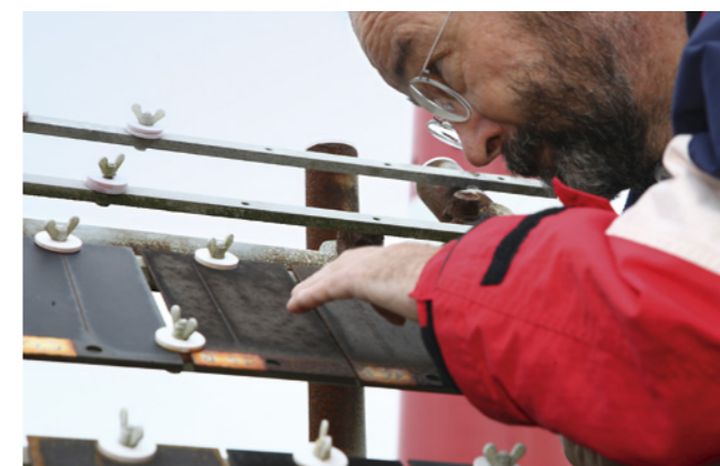
Bloß nicht anfassen! Fingerabdrücke könnten das Ergebnis verfälschen. Selbst die Halteschrauben bestehen aus neutralem Kunststoff
