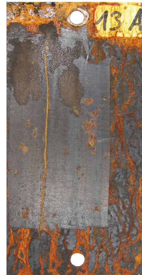
So wie hier zeigt sich das wahre Ausmaß der Unterrostung erst, wenn die Beschichtung abgekratzt wird
