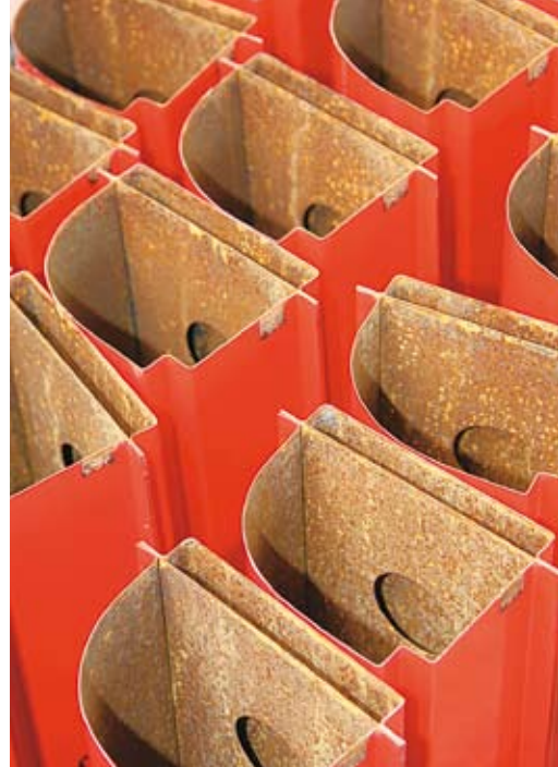
So sahen die Testschweller übrigens vor der Behandlung aus: gleichmäßig angerostet
