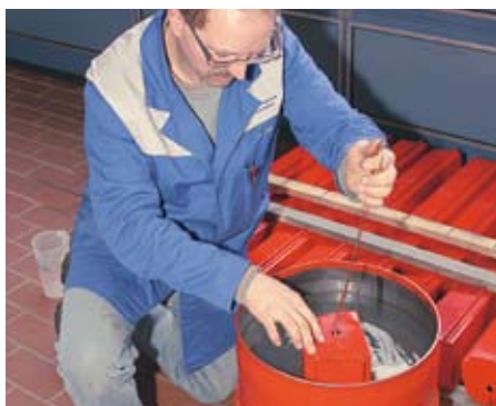
Beim zweiten Mal entschieden wir uns für ein Salz-Tauchbad. Damit war sichergestellt,...
