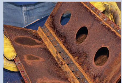
Dabei lässt es sich nicht vermeiden, dass Rost durch die Löcher in die Hauptkammer rieselt
