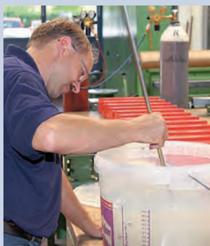
...für die erste Salzdusche im großen Eimer an. Exakt 100 Milliliter Salzlösung werden...
