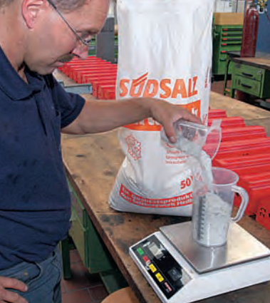
Ein Kilo Streusalz auf 20 Liter Wasser: Thomas Geis von der FAS rührt die Sprühlösung...
