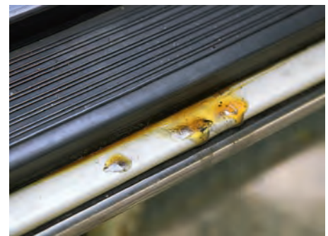
Aus den Türen tropfte das Fett hier auf den Schweller: Fettfleckgefahr für die Hose
