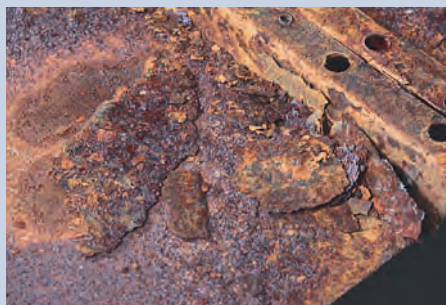
... der Produkte. Hier (Elaskon) zeigt sich schon nach zwei Jahren deutlicher Blattrost
