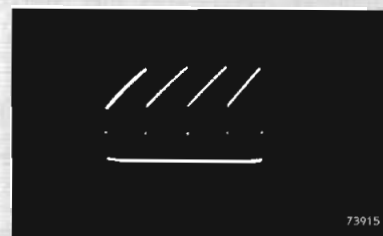
Zaagtandspanning met impulsen, waarbij gebruik gemaakt is van de Philips Electronenschakelaar GM 4580/01.
