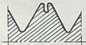
Rys.2. Zarys wygniatanego gwintu
