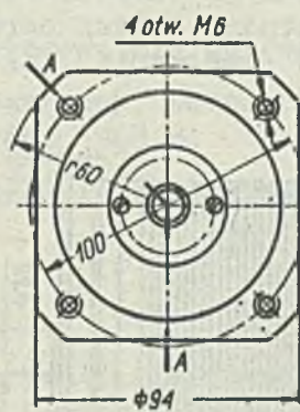
Rys. 12. Wymiary montażowe silnika SK-80/50
