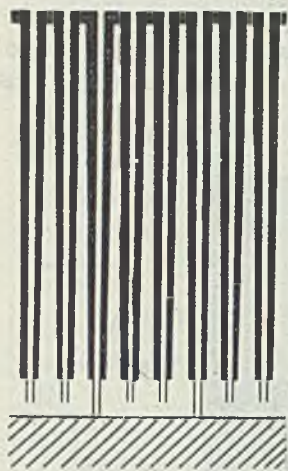
Rys. 1. Schemat budowy powłoki anodowej
