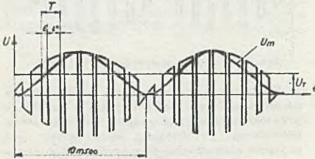
Rys. 5. Wyjściowy przebieg z przetwornika o "modulacji przestrzenno-amplitudowej"
