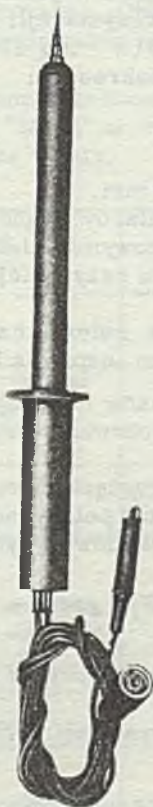
Fot. 4. Sonda wysokiego napięcia typu P 223
