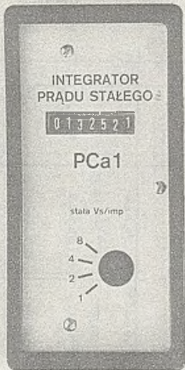
Fot. 2. Widok ogólny przetwornika w obudowie P2
