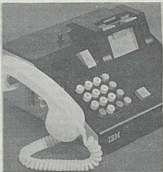
Fot. 1. Terminal firmy IBM typu 3221 zawierający aparat telefoniczny, 16 klawiszy i czytnik kart
