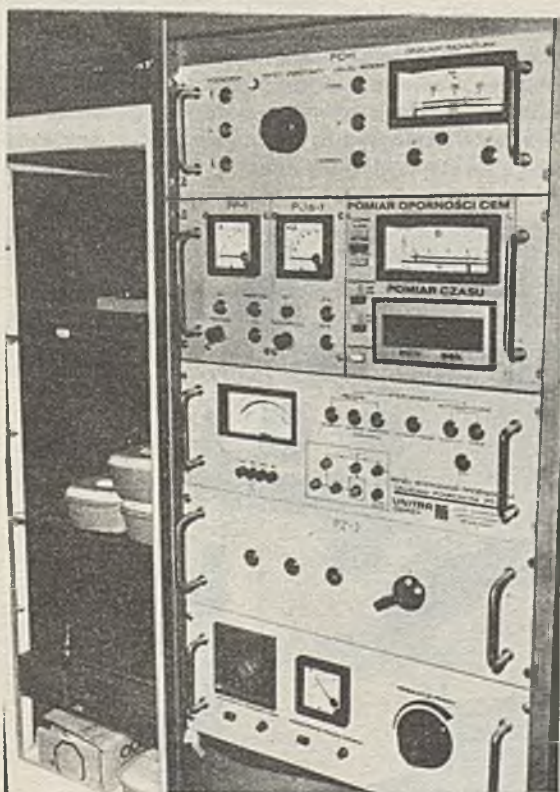
Fig. 1. Widok panelu do sterowania pracą napyłarki NA 501 P z wbudowanymi układami regulacji i kontroli podczas naparowywania cienkich warstw magnetycznych
