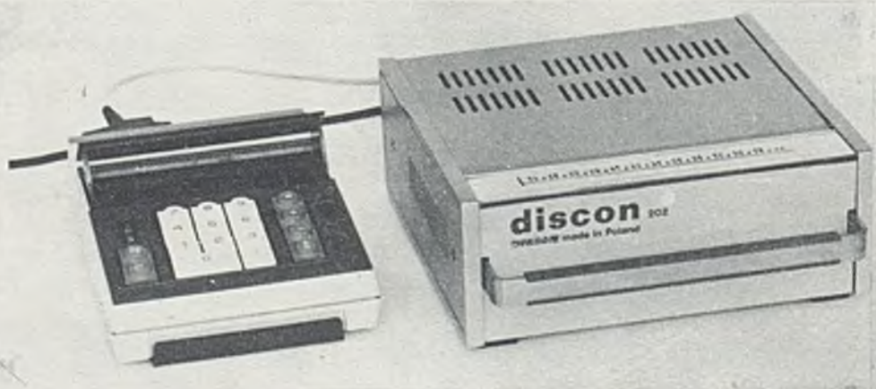
Fot. 1. Discon 202 - przetwornik wskazań cyfrowych
