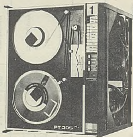
Fot. 3. Pamięć PT 305 /PE/NRZ1/ z buforem ramieniowym produkcji "Meramat"
