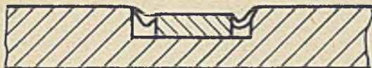
Rys. 5. Połączenie spawane elementu z "masą" z wykorzystaniem kanałka technologicznego o głębokości do 0,3 mm. Luz pomiędzy krawędziami cienkiego elementu /taśma, drut/ i bocznymi ściankami kanałka powyżej 0,15 mm
