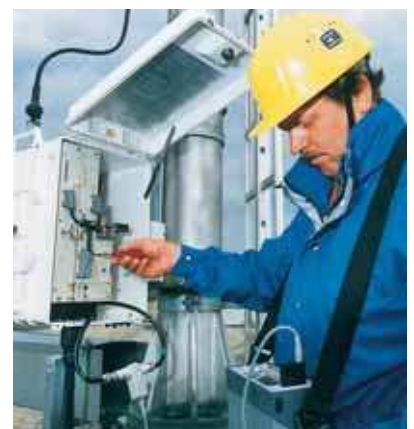
Level Meter R&S®URV35 mit Durchgangsmesskopf R&S®URV5-Z2 im mobilen Einsatz
