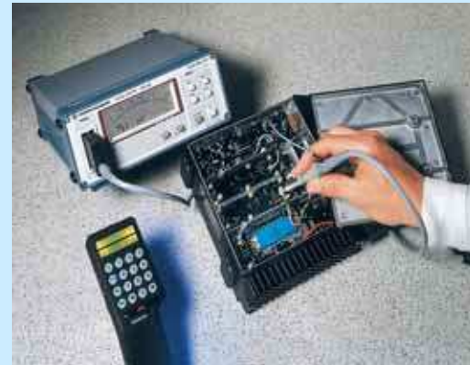
Belastungsarme Spannungsmessung mit HF-Tastkopf R&S®URV5-Z7
