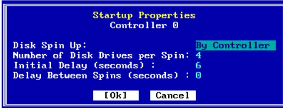
**Figure 3-9. Startup Properties Screen**
